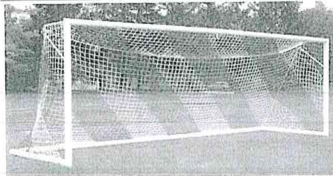
Coppia porte gioco calcio modello spostabile in profilato di alluminio, a sezione ovale di mm.120x105, rinforzato connervature interne antiflessione. Complete di ganci in plastica per attacco reti, reggireti posteriori e struttura di sostegno in acciaio verniciato da appoggiare a terra. Dim.cm.732x244 Reti escluse, picchetti di fissaggio compresi.
