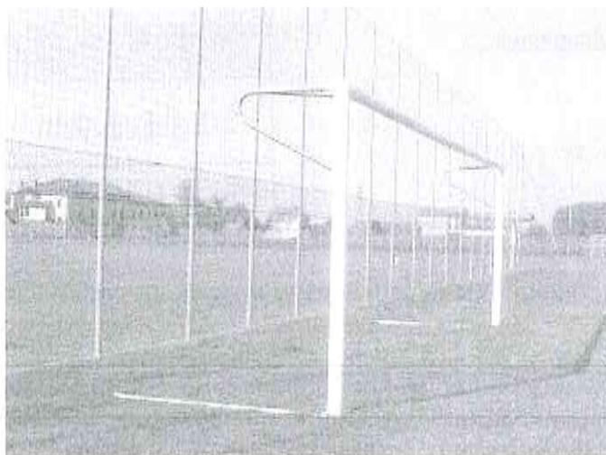
Rete per porte da calcio in treccia di nylon alta tenacità Ø 3,5 mm stabilizzato UV. Lavorata senza nodo e completamente bordata sul perimetro, completa di corda per l'aggancio. Maglia esagonale. Dimensioni: 7,50x2,50 m. Fianco Alto 1,00 m Fianco Basso 2,00.
